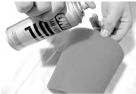
CONFIGURAZIONE TIPICA - OLIARE L'ELEMENTO FILTRO IN MATERIALE ESPANSO
