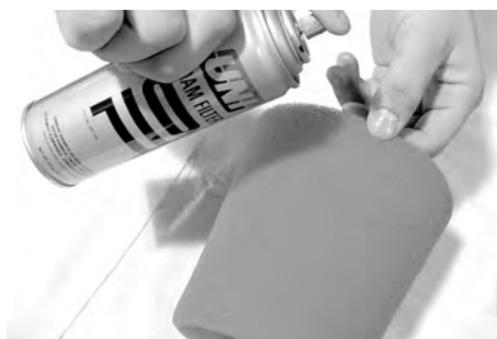
TYPIQUE – HUILER LE FILTRE EN MOUSSE
