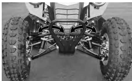
POINTS D'ARRIMAGE DES SANGLES AU PARE-CHOC AVANT
