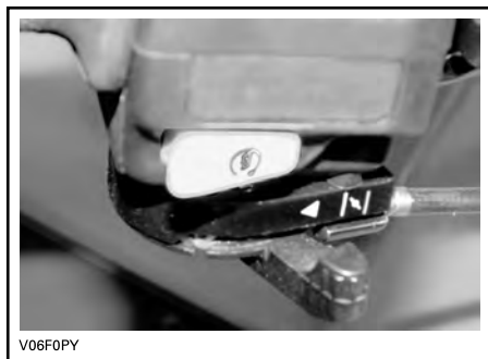
CHOKE GEÖFFNET, HEBEL IN UNBETÄTIGTER STELLUNG
