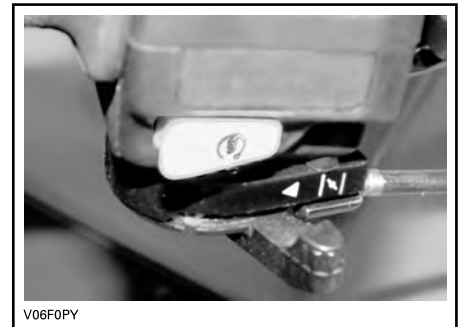
CHOKE GEÖFFNET, HEBEL IN UNBETÄTIGTER STELLUNG
