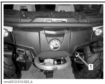
1. Deksel for oppbevaringsrom bak
