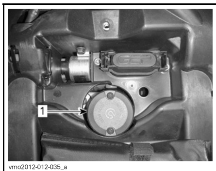
1. Bremsevæskebeholder for bremsler bak
