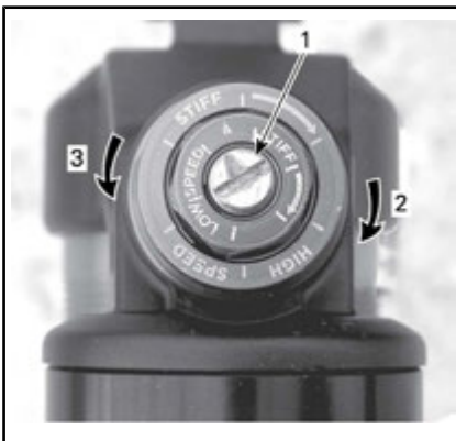
COMPRESSIEDEMPING BIJ LAGE SNELHEID (GEBRUIK EEN SCHROEVENDRAAI-ER)
