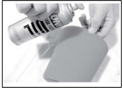
SITUAZIONE TIPICA - LUBRIFICARE IL FILTRO IN MATERIALE ESPANSO
