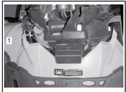
1. Serbatoio liquido refrigerante motore
