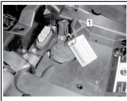
1. Raccordo del compressore
