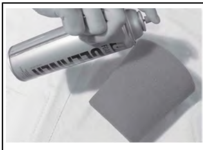
TÍPICO - ROCÍE EL FILTRO DE ESPUMA.
