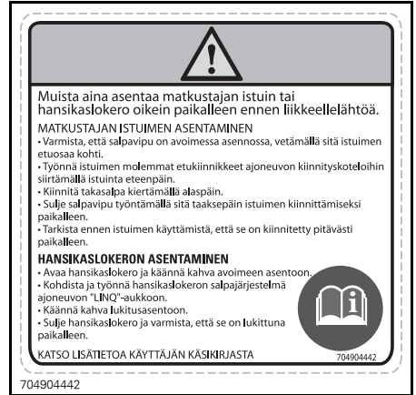
KILPI 11 - SIJAITSEE HANSIKASLOKERON ALAPUOLELLA
