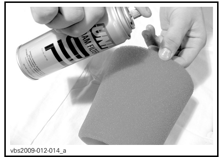
vbs2009-012-014_a TYPIQUE - HUILER L'ÉLÉMENT EN MOUSSE
