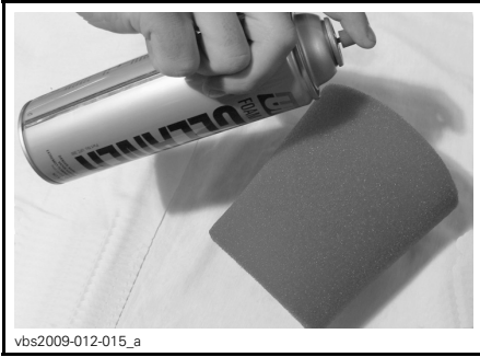
vbs2009-012-015_a TYPIQUE - IMPRÉGNER L'ÉLÉMENT EN MOUSSE
