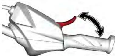
A alavanca do acelerador é acionada por mola e deve voltar à posição de descanso quando não estiver pressionada.
