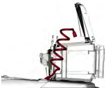
Para drenar, desaparafuse as conexões em três (3) a cinco (5) giros.
