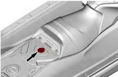
Insira a haste no orifício de montagem. Prenda usando a correia. A haste pode ser instalada da frente para trás. Você ouvirá um clique para confirmar a instalação da haste. Uma mensagem será exibida no display digital se houver um mau funcionamento do sistema. Entre em contato com sua concessionária se isso ocorrer.
