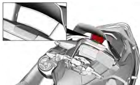
Ele é montado em um sistema de liberação rápida e inclinará para a frente se houver um impacto com o usuário.
