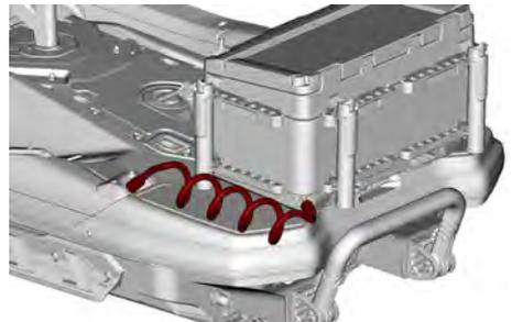
**OBSERVAÇÃO:** A mangueira de enchimento de água pode ser direcionada entre o recipiente térmico e um suporte de haste para evitar arqueamento.
