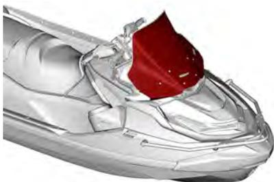
O para-brisa está equipado com um basculante que permite a passagem do ar.
