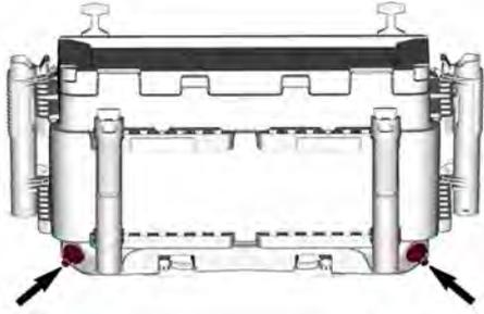
Instale os tubos dentro do recipiente térmico parafusando-os nos novos encaixes roscaados.
