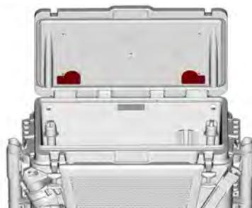
Remova os dois bujões de drenagem e instale os encaixes roscados do reservatório para peixes.
