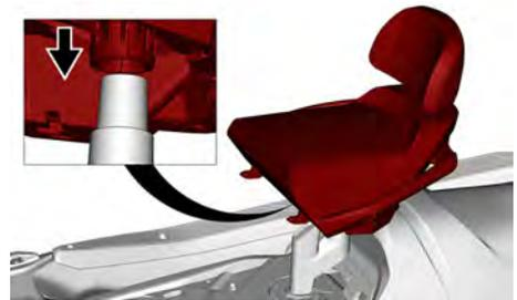
Para instalar corretamente o encosto, assegure-se de que ele esteja completamente inserido. Uma distância de 10 mm (3/8 pol.) é normal.
