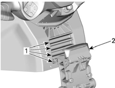
**TÍPICO – TRAVA DE AJUSTE DA COLUNA DE DIREÇÃO ENCAIXADA**
