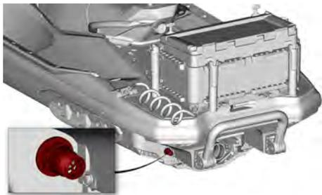
A água fresca pode ser fornecida por 30 segundos a cada três minutos ou continuamente, controlado pelo interruptor. A função intermitente foi projetada para minimizar a drenagem da bateria quando o motor está desligado.
