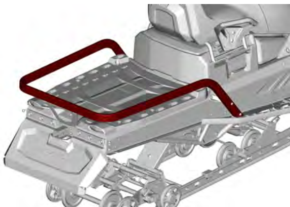
BAGASJE - KRAFTIG STØTFANGER — 20" OG 24" TUNNEL
