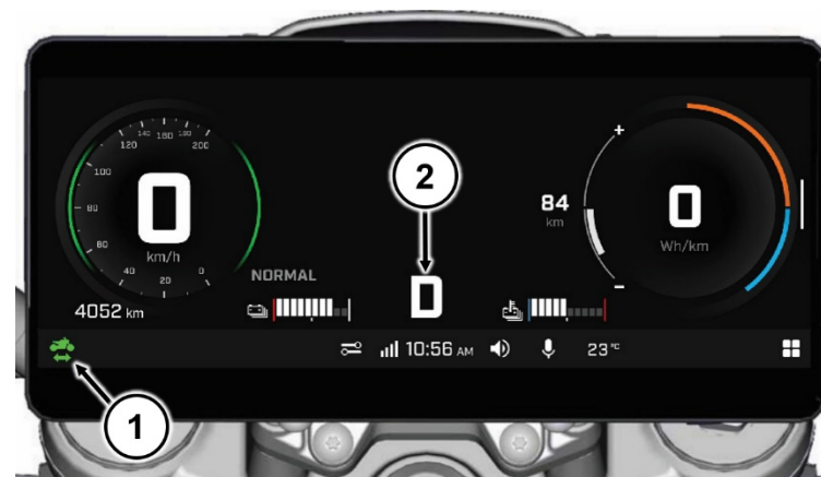
Högspanning inkopplad OCH framdrivningssystem aktiverat
