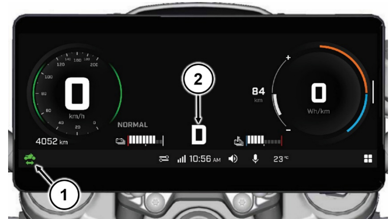
Korkeajännite käytössä JA ajovoimajärjestelmä käytössä
