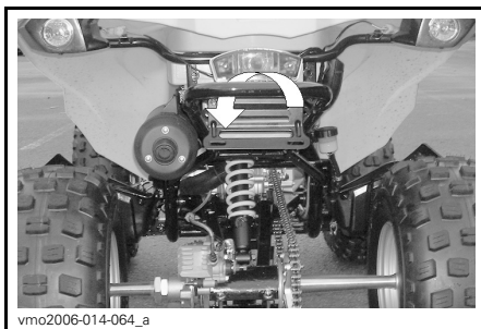
PARE-CHOCS ARRIÈRE — POINT D'ARRIMAGE DES SANGLES
