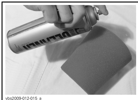
TYPIQUE - VAPORISER DU NETTOYEUR DE CHAQUE CÔTÉ DE L'ÉLÉMENT
