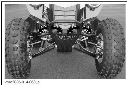
PARE-CHOCS AVANT — POINTS D'ARRIMAGE DES SANGLES
