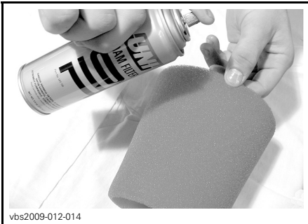
TYPIQUE - HUILER L'ÉLÉMENT EN MOUSSE
