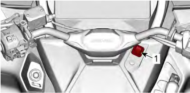
1. Interruptor de luces de emergencia
