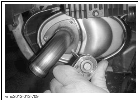
vmo2012-012-709 TYPIQUE - RETRAIT DU TUYAU ARRIÈRE
