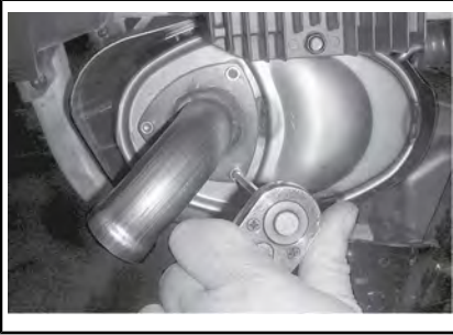
TÍPICO - REMOVA O CANO DE ESCAPAMENTO
