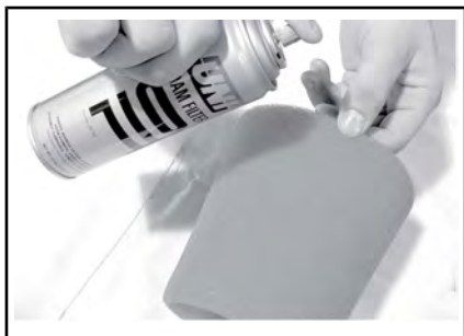
TÍPICA - LUBRIFIQUE O FILTRO DE ESPUMA
