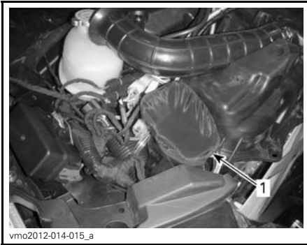
1. Filtre à air de la transmission CVC
