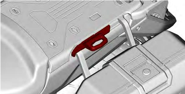
6. Per conservare gli attacchi LinQ, rimuovere la piastra di supporto multifunzione; fare riferimento a [Rimozione della piastra di supporto multifunzione, pagina 3-37](#).
