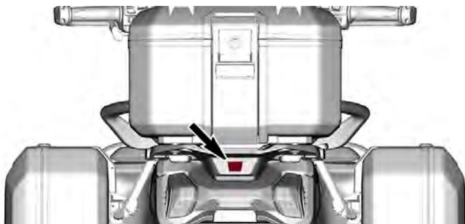
Elle fonctionne automatiquement lorsque le moteur tourne et que la marche arrière est enclenchée.
