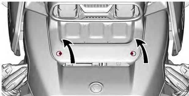
2. Levante y deslice hacia adelante la cubierta de servicio frontal.
