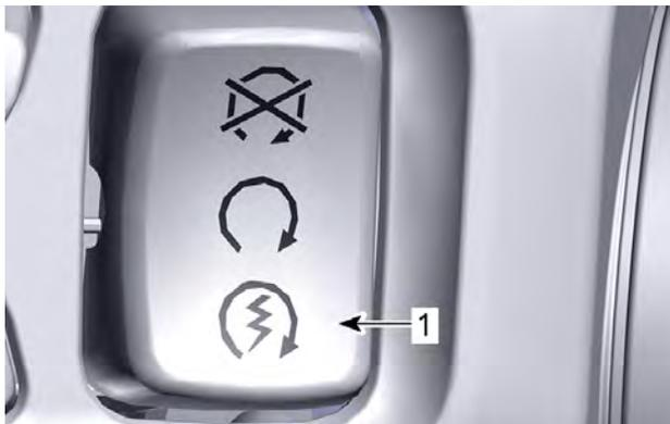
1. Posición de arranque del motor
