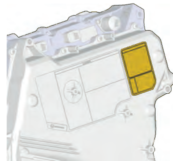
Batteria ad alta tensione
