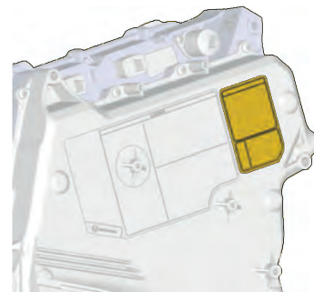
Batterie haute tension
