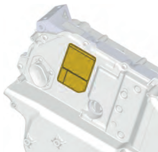
Batterie haute tension
