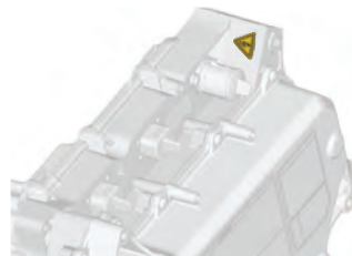
Batterie haute tension
