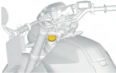
Réservoir de liquide de refroidissement
