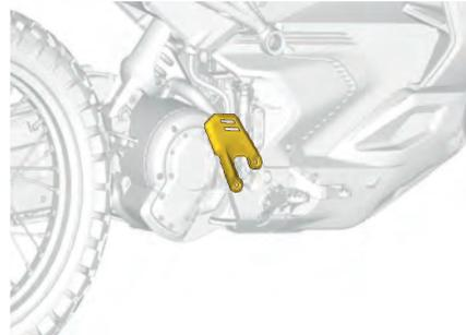
2. Installare le viti di fissaggio del paratalloncini. Serrare come da specifiche.
