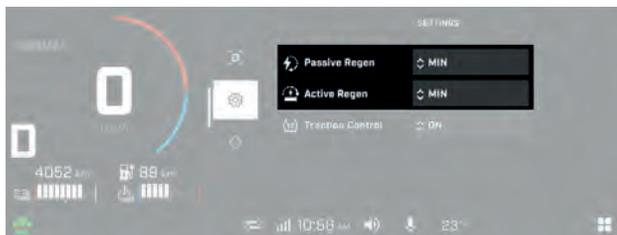
La disponibilità della frenata rigenerativa varia in funzione di queste impostazioni e di altri parametri come lo stato di carica e la temperatura della batteria ad alta tensione. Il display multifunzione mostrerà sempre la capacità di frenata rigenerativa attualmente disponibile come descritto nella sezione [Display multifunzione, pagina 3-39](#).
