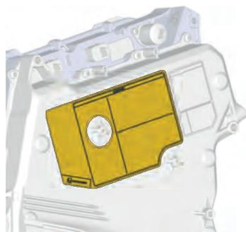
**Batteria ad alta tensione**
