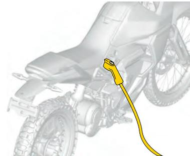
7. Assicurarsi che il cavo di ricarica della EVSE sia correttamente bloccato nella porta di ricarica del veicolo.
