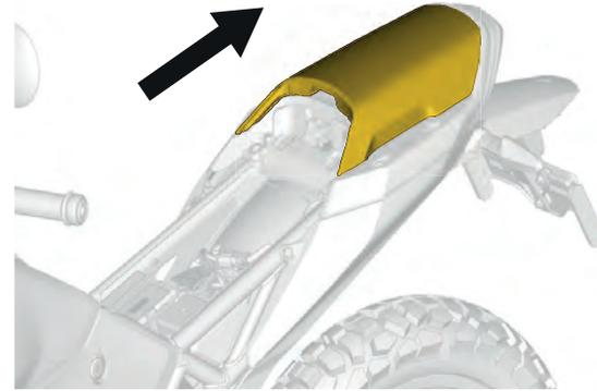
2. Installare il sedile del conducente. Fare riferimento a [Installazione del sedile del conducente, pagina 3-23](#).
