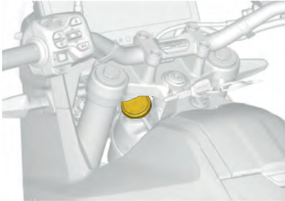
Réservoir de liquide de refroidissement
