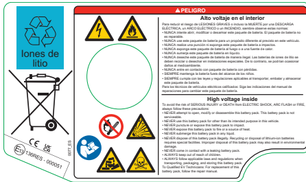
Etiqueta de peligro de la batería de alto voltaje
