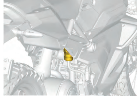
Depósitos de líquido de frenos de la parte trasera
