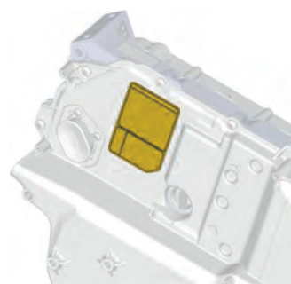
Batería de alto voltaje
