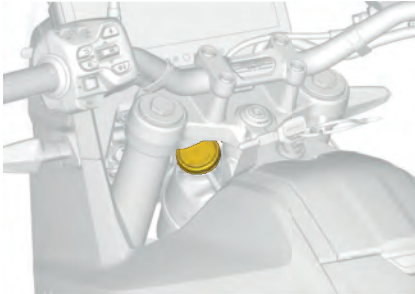
Depósito del refrigerante
