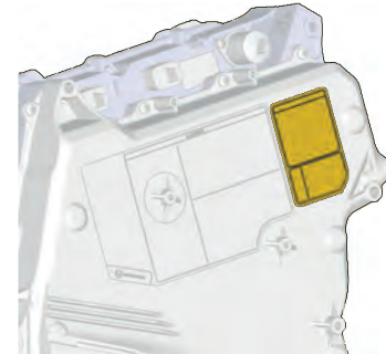
Batería de alto voltaje
