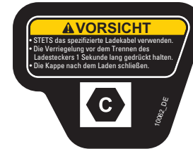
Schild mit Anweisungen zum Laden – Modelle für Kanada und USA
