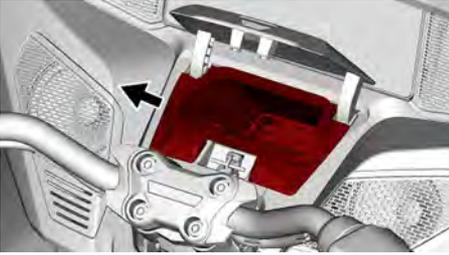
2. Inserire la mano nell'apertura e premere sulla parte in gommapiuma sotto il display, per accedere alla parte interna della consolle. Può essere necessario mettere di lato i cablaggi elettrici per lavorare più facilmente.
