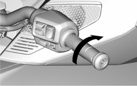
4. Premere l'interruttore di avvio del motore fino all'accensione del motore. Non premere il pulsante di avvio per più di 15 secondi. Se non si avvia, rilasciare il pulsante e attendere 30 prima di riprovare per consentire al motorino di avviamento di raffreddarsi.
