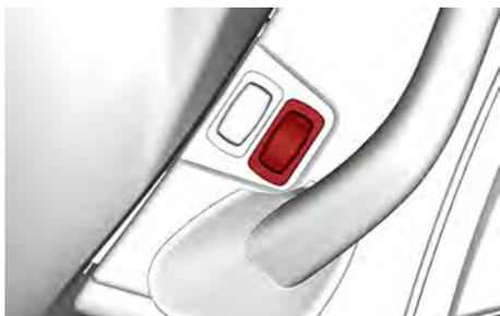
L'interruttore delle manopole riscaldate permette di accendere o spegnere il riscaldamento delle manopole e di controllare l'intensità del calore.
