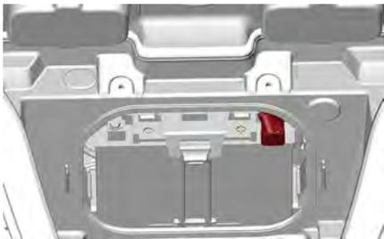
6. Iniziare collegando un'estremità del cavo con terminale ROSSO al terminale positivo (+) della batteria scarica.
