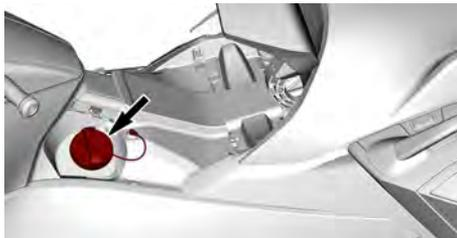
4. Ruotare lentamente il tappo in senso antiorario e rimuoverlo.
