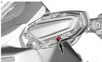
2. Rimuovere la vite sull'estremità dell'alloggiamento specchietto.
