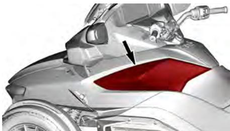
Il coperchio di manutenzione sinistro deve essere rimosso per raggiungere il filtro dell'aria del motore.
