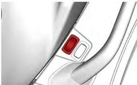
L'interruttore delle selle riscaldate permette di accendere o spegnere il riscaldamento delle selle e di controllare l'intensità del calore.
