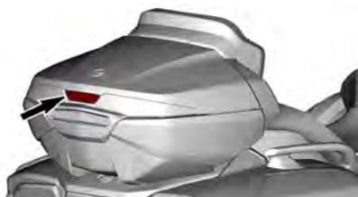
Tirez sur le verrou pour ouvrir le couvercle. S'il est verrouillé, utilisez la clé de contact pour le déverrouiller.
