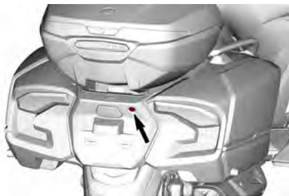
Cette caméra fonctionne automatiquement lorsque le moteur tourne et que la marche arrière est enclenchée; elle est désactivée dès que le véhicule n'est plus en marche arrière.
