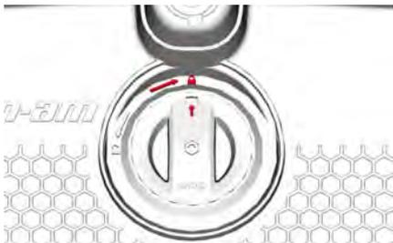
6. Saisissez fermement le compartiment de rangement et vérifiez qu'il est correctement installé et verrouillé sur le véhicule.
