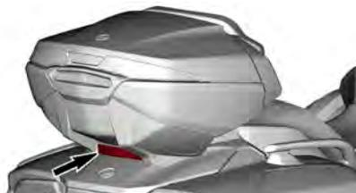
4. Soulevez légèrement le compartiment de rangement et glissez la main en dessous pour débrancher le connecteur situé près du siège passager.
