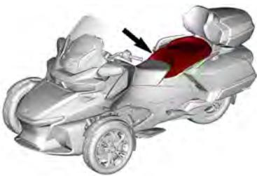
2. Retirez les deux vis de fixation du panneau d'accès.
