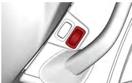
L'interrupteur des poignées chauffantes sert à mettre les poignées chauffantes sous et hors tension et à contrôler l'intensité de la chaleur.
