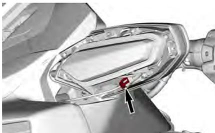
2. Retirez la vis située à l'extrémité de la coque du rétroviseur.
