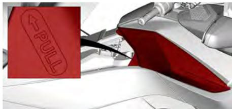
3. Tirez sur le couvercle de service pour le sortir du véhicule.
