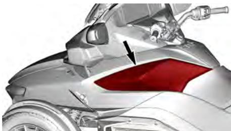
Le couvercle de service gauche doit être retiré pour accéder au filtre à air du moteur.
