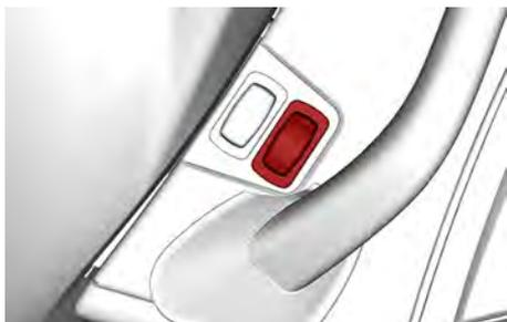
El interruptor de las empuñaduras con calefacción permite activar y desactivar la calefacción de las empuñaduras y controlar la intensidad del calentamiento.
