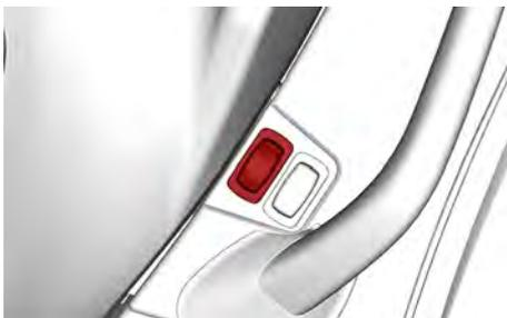
El interruptor de los asientos con calefacción permite activar y desactivar la calefacción de los asientos y controlar la intensidad del calentamiento.
