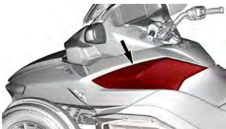
La tapa de acceso izquierda se puede desmontar para acceder al filtro de aire del motor.
