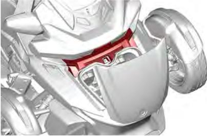
La tapa de acceso delantera se puede desmontar para acceder a los elementos siguientes:
