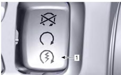
1. Posición de arranque del motor
