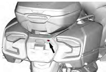
Esta cámara entra en funcionamiento automáticamente cuando el motor está en marcha y se selecciona REVERSA y se desactiva en cuanto deja de seleccionarse REVERSA.
