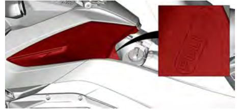
EINBAULAGE DER BEFESTIGUNGLASCHEN
