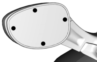
ミラー調整ポイント - STDおよびSモデル
