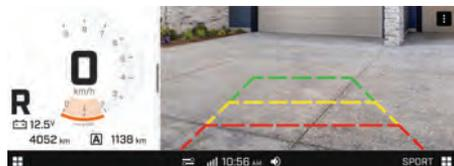
Quando la videocamera è attiva, sullo schermo vengono visualizzate delle linee guida fisse che servono durante la manovra.
