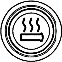
Il pulsante delle manopole riscaldate consente di accendere e spegnere le manopole riscaldate del conducente e selezionare l'intensità.
