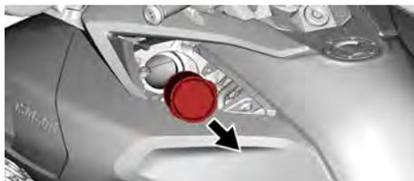
**CONFIGURAZIONE TIPICA - RIMUOVERE IL FILTRO DELL'ARIA DAL SILENZIATORE DI ASPIRAZIONE DELL'ARIA.**
