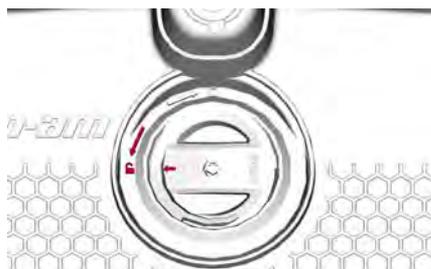
Se la manopola è dura da ruotare, installare sulla manopola la maniglia sagomata fornita in dotazione per avere una presa migliore. Questa maniglia sagomata è posta sulla parete del vano.
