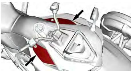
**Rimozione del coperchio di manutenzione laterale**
