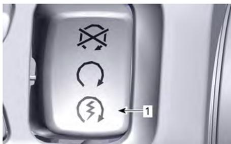
1. Posizione di avviamento del motore
