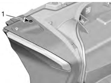
1. Vite di fissaggio superiore
