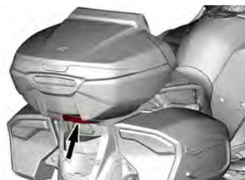
4. Soulevez légèrement le compartiment de rangement et glissez la main en dessous pour débrancher le connecteur situé près du siège passager.
