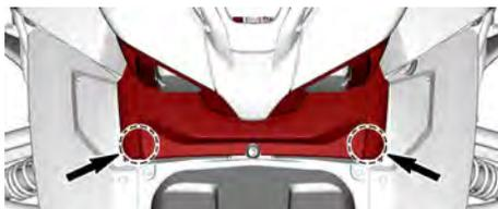
2. Tirez sur le couvercle de service vers l'avant pour le sortir du véhicule.
