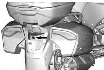
Cette caméra fonctionne automatiquement lorsque le moteur tourne et que la marche ARRIÈRE est sélectionnée. Elle est désactivée dès que la marche ARRIÈRE n'est plus sélectionnée.
