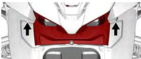
2. Alignez les languettes du couvercle avec les ancrages du véhicule.
