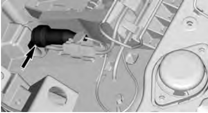
DC56 - CIRCUITO TRASERO PARA ACCE- SORIOS DEL CLIENTE - BAJO EL ASIEN- TO DEL PASAJERO
