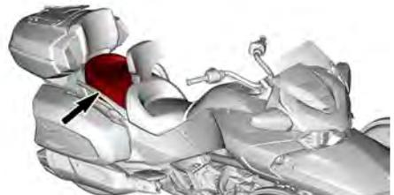
2. Rückenlehne leicht nach vorn ziehen, um sie zu entriegeln, dann anheben und ausbauen.
