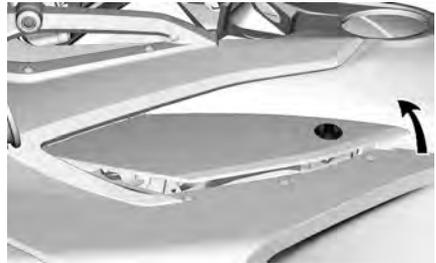
3. Ziehen Sie die Wartungsabdeckung zum Entfernen nach hinten.
