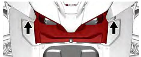
2. Achten Sie darauf, dass Sie die Abdeckungs-laschen mit den Fahrzeugverankerungen ausrichten.
