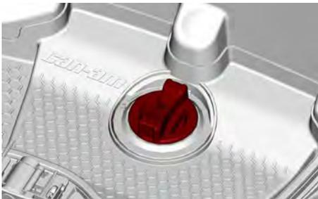
**DER GEFORMTE GRIF WIRD ÜBER DEM LINQ-KNOPF INSTALLIERT.**
