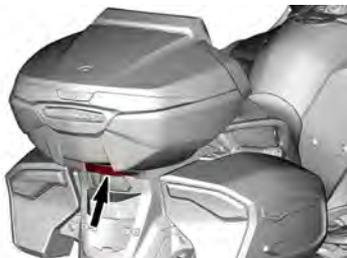
4. Heben Sie das Staufach leicht an und schieben Sie Ihre Hand darunter, um den Steckverbinder neben dem Mitfahrersitz abziehen.
