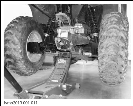
TYPEBILDE – PLASSERING AV OPP BAK-PUNKT
