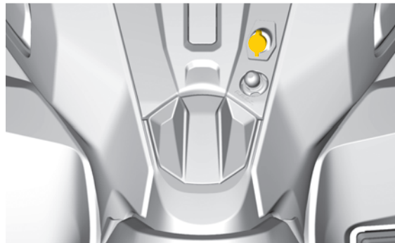
Plassering av kontakt for oppvarmet visir
