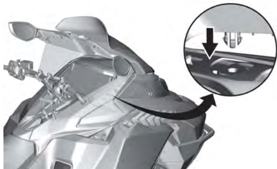
Typique – photo de pare-brise avec déflecteurs
