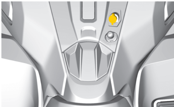
Lämmitettävän visiirin liittimen sijainti
