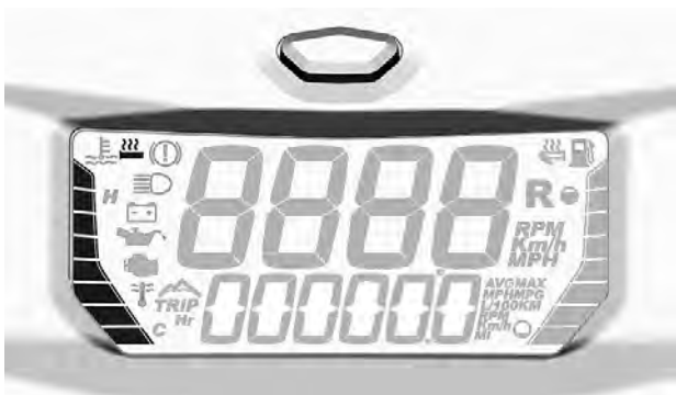
Display della leva dell'acceleratore riscaldata
