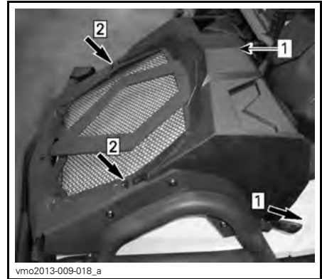
Step 1: Lossa spärren Step 2: Tryck på flikarna
