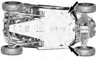
KRIKPOSITIES - VOORKANT VAN HET VOERTUIG
