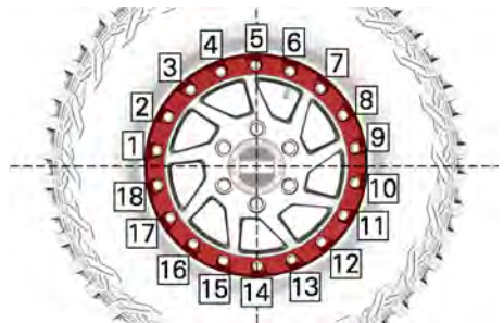
TYPISCH - LAATSTE AANDRAAIVOLGORDE
