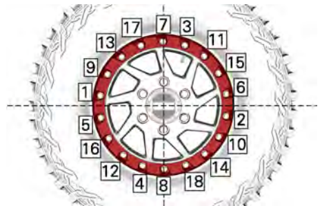
SITUAZIONE TIPICA - SEQUENZA DI SERRAGGIO
