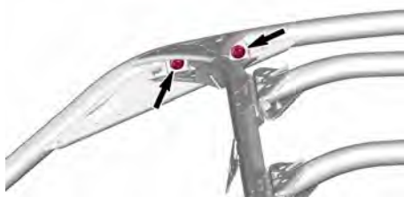
DISPOSITIVI DI FISSAGGIO ANTERIORI SUPERIORI
