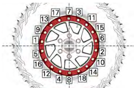
SITUAZIONE TIPICA - SEQUENZA DI SERRAGGIO
