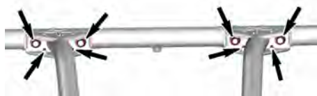
DISPOSITIVI DI FISSAGGIO ANTERIORI
