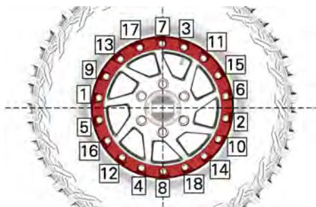
SITUAZIONE TIPICA - SEQUENZA DI SERRAGGIO
