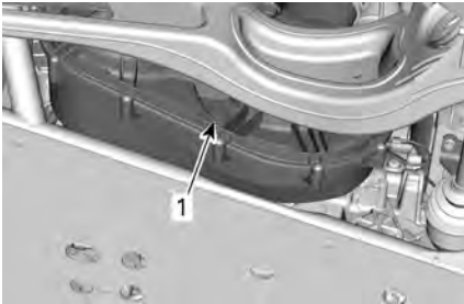
1. Drenaje de la CVT
