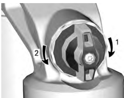
TYPBILD - JUSTERING AV DELNINGS-PUNKT - BAKRE STÖTDÄMPARE
