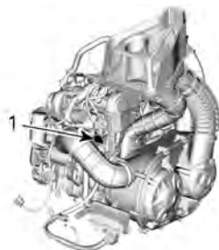
TYPBILD — DEKAL FÖR MOTORN'S TILLVERKNINGSNUMMER
