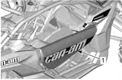
1. Porta fechada e corretamente travada
