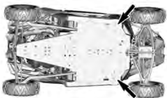
POSIÇÕES DE APOIO DO MACACO - PARTE DIANTEIRA DO VEÍCULO
