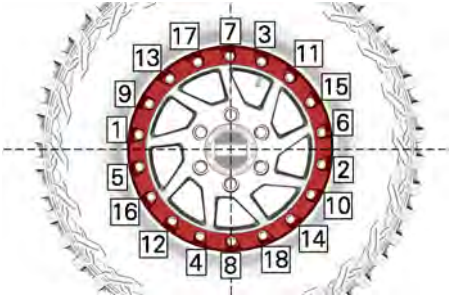
TYPISCH - AANDRAAIVOLGORDE
