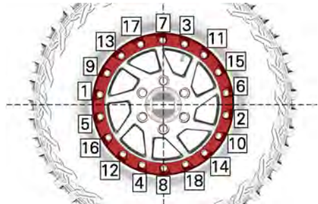
TYPISCH - AANDRAAIVOLGORDE
