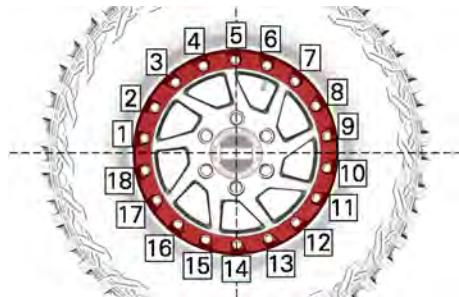
TYPISCH - LAATSTE AANDRAAIVOLGORDE
