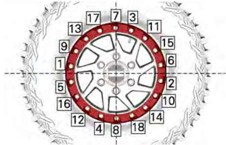
TYPISCH - AANDRAAIVOLGORDE
