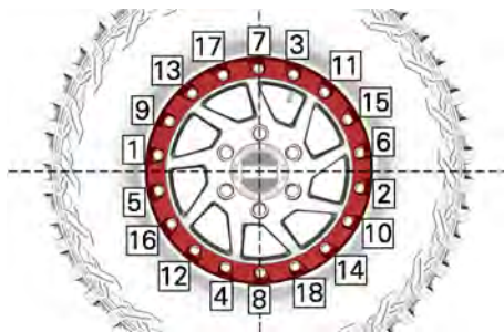
SITUAZIONE TIPICA - SEQUENZA DI SERRAGGIO
