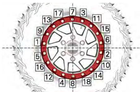
SITUAZIONE TIPICA - SEQUENZA DI SERRAGGIO
