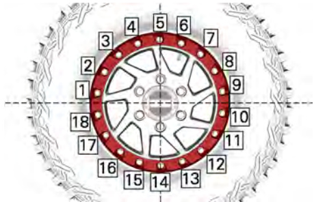
TYPIQUE - SÉQUENCE DE SERRAGE FINAL
